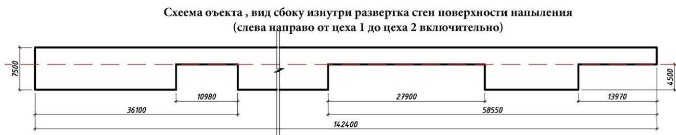
Рисунок 4. Развертка стен поверхности напыления, вид сбоку изнутри
